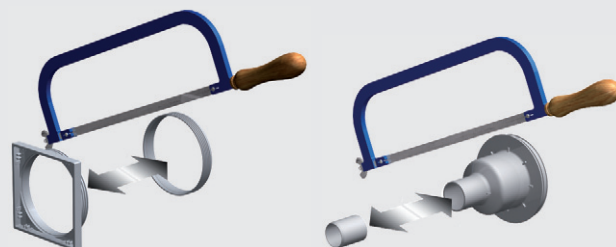
Support de grille – Adaptation de la hauteur du cadre à l'épaisseur de carrelage souhaitée
