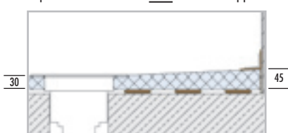
Siphon de sol vertical sans élément support
