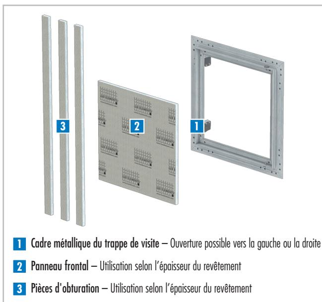
Trappe de visite ADD-TE REV – Adaptation de la hauteur de montage via les pièces d'obturation pour des épaisseurs de revêtement de 2 ou 12 mm :
