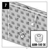
Alle Elementstöße und Übergänge mit Glasfaserarmierungsstreifen ARM-100 SK armieren und ....
